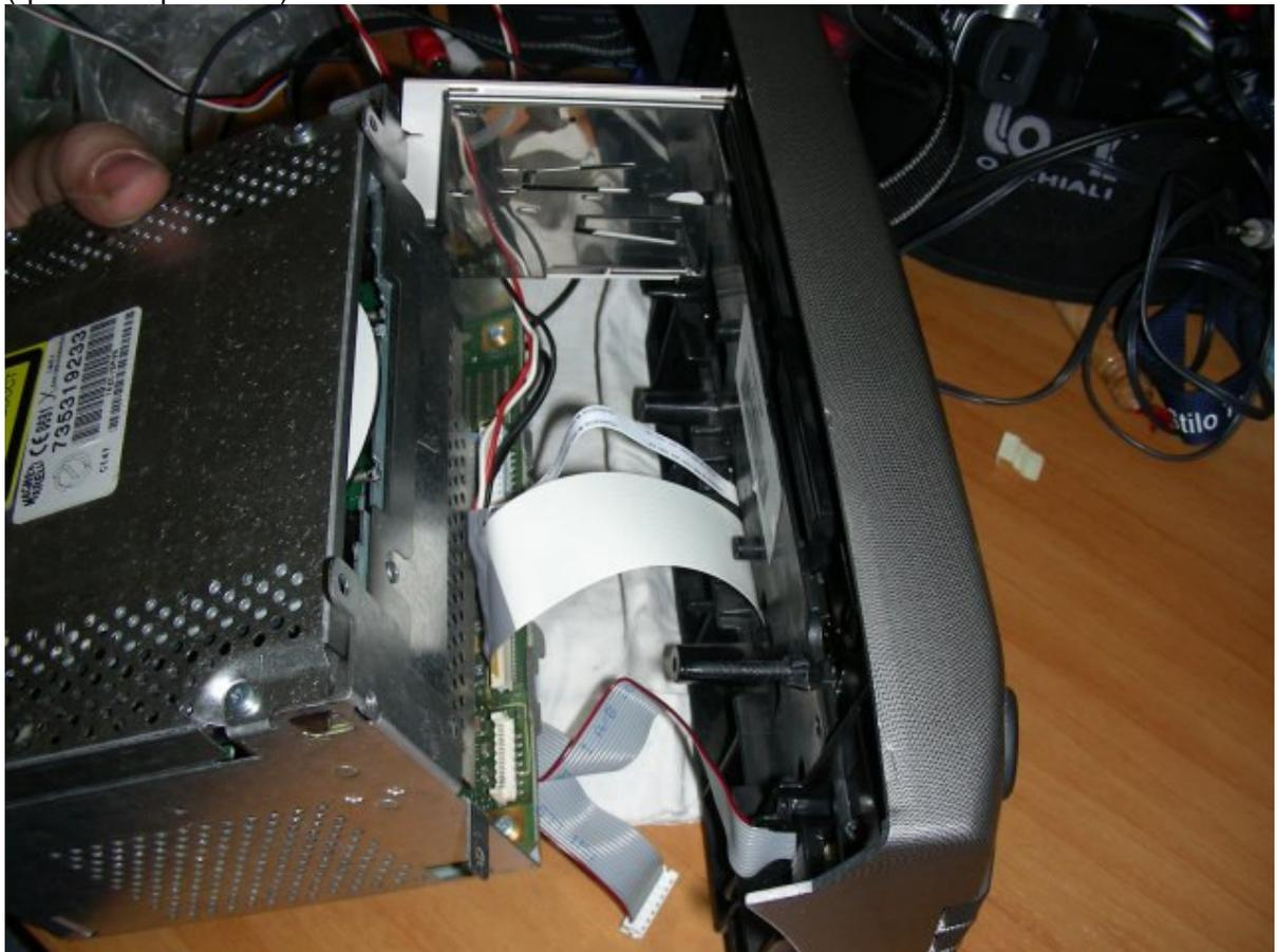
Avvicinate ora il pannello frontale al corpo centrale del connect facendo attenzione a inserire correttamente il lettore di simcard e controllando che i cavi non si dispongano in strane maniere, comunque il kit è molto preciso e non dovrebbe dare nessun problema di sorta.
