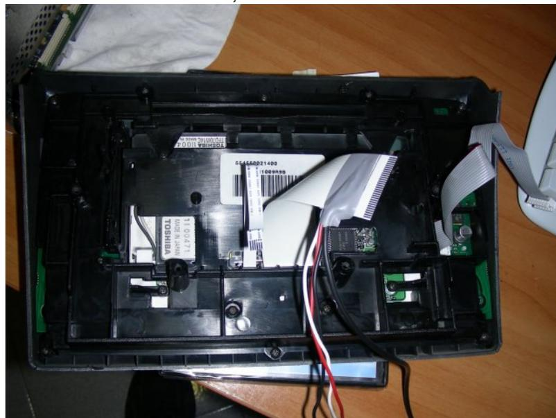
Ora arriva la parte un pochino più complicata: il fissaggio dei connettori nel corpo centrale del connect. Onde evitare di rovinare irrimediabilmente il kit video, vi consiglio di collegare per primo il connettore del lettore simcard che ha un filo abbastanza lungo da potervi far ancora muovere in tranquillità.
